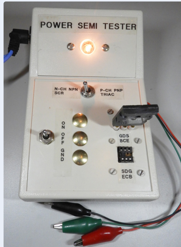
Figuur 2. Een eenvoudige tester voor transistoren, MOSFET's, thyristoren en triacs.
