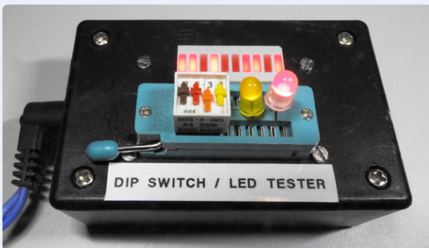
Figuur 3. Een DHZ-tester voor DIP-schakelaars en LED's, hier tijdens het testen van een viervoudige DIP-schakelaar en een paar LED's.
