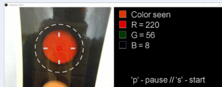
Figuur 6. computer_vision.pde levert de RGB-waarden die de camera 'ziet' voor elke kleur van het verkeerslicht.
