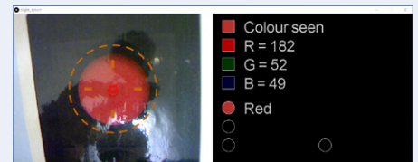
Figuur 9. tlight_detect.pde nadat het de kleuren rood, geel en groen heeft geleerd.
