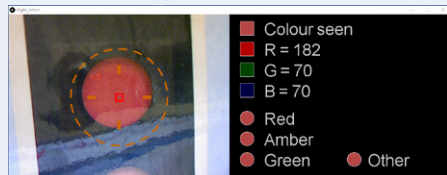
Figuur 7. De respons van tlight_detect.pde voordat het kleuren heeft geleerd.
