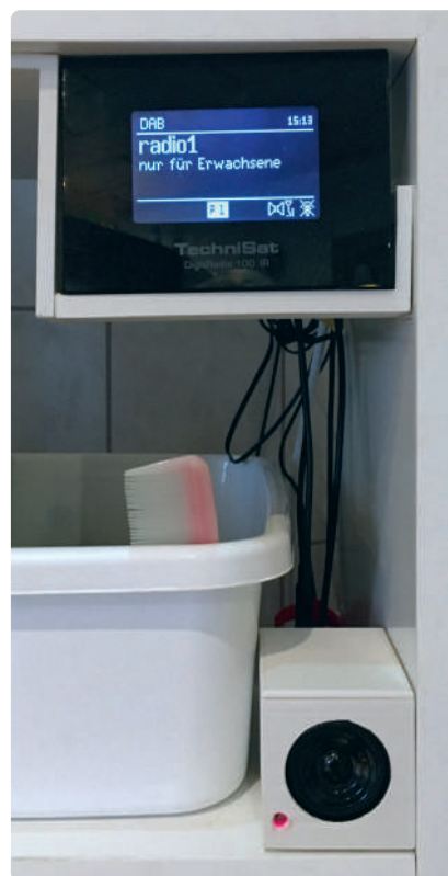
Figuur 1. In de badkamer zit de digitale radio (zonder versterker) boven de zelfgebouwde actieve luidspreker met automatische inschakeling.
