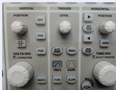
Figuur 4. De belangrijkste drie besturingsecties van elke oscilloscoop: Vertical, Horizontal en Trigger.
