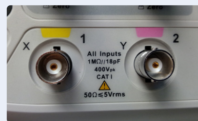
Figuur 5. De X- en Y-ingangen worden gebruikt in XY-modus, waarmee je bijvoorbeeld Lissajous-figuren kunt maken.
