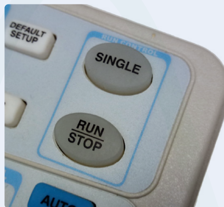
Figuur 10. Met de knoppen Run, Stop en Single kunnen infrequente meetsituaties worden vastgelegd of metingen worden bevroren zonder dat het signaal verdwijnt.
