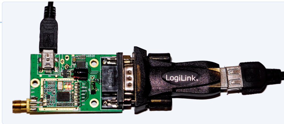
Figuur 2. De draadloze UART/RS232-modules moeten worden geconfigureerd. Op de foto zijn de jumper en de groene en rode LED's te zien.
