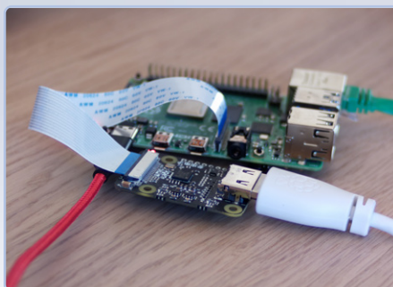
Figuur 18. De complete opstelling met HDMI-naar-CSI-brug.
