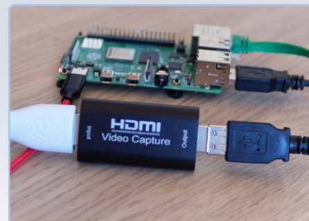
Figuur 19. De complete opstelling met HDMI USB-dongle.
