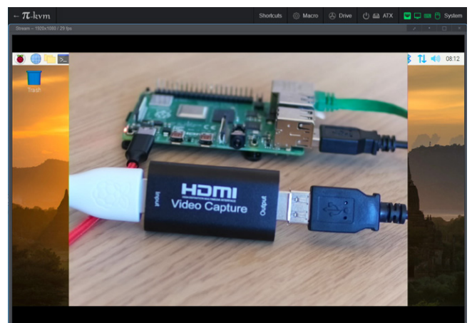
Figuur 22. Bureaublad van de Raspberry Pi-camera, met HDMI USB-dongle.
