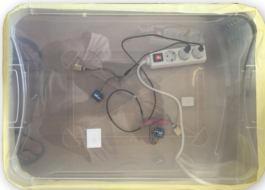
Figuur 6: Test van verschillende sensoren met bepaalde CO 2 -concentraties.
