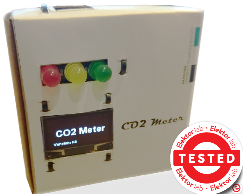
Figuur 1: Afgerond apparaat met verkeerslicht en display in een kartonnen behuizing.
