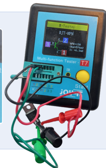
Figuur 3: Testen van componenten in de ZIF-socket of met de testclips.
