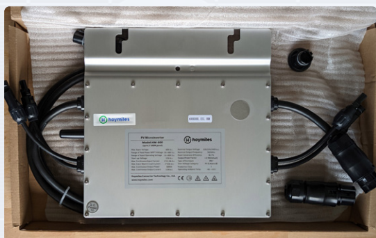
Figuur 5: De andere kant van de HM-600 grid-tie inverter.
