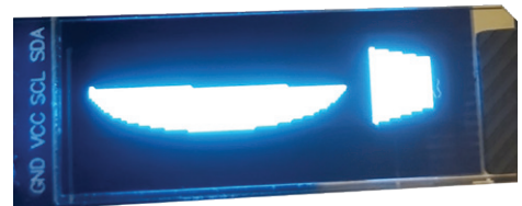
Figuur 10: De weergave na het uitvoeren van OLEDShape2.py (koorde en polygoon).
