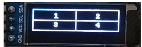
Figuur 9: Het beeld na het uitvoeren van OLEDShape1.py (rechthoeken).
