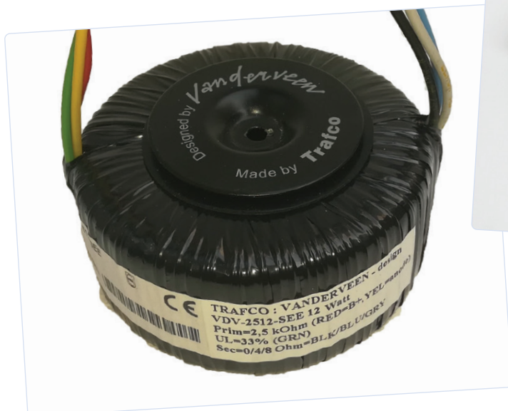
Figuur 5. Een Vanderveen-ringkerntrafo.
