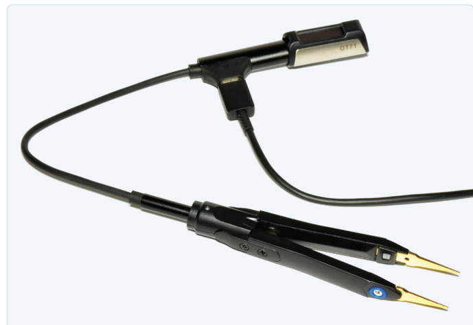
Figuur 2. Display- en pincetgedeelte kunnen zo met elkaar worden verbonden en opgeladen via een USB-C-kabeltje.
