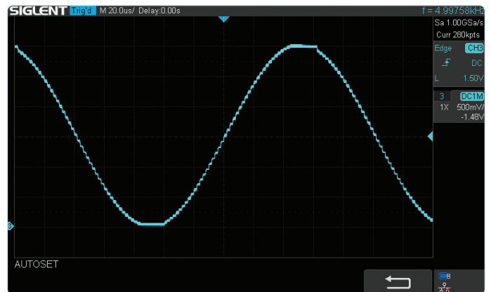
Figuur 5. Het uitgangssignaal van de frequentiegenerator, de sinus (hier 5 kHz) is iets afgeplat en de stappen zijn duidelijk zichtbaar.
