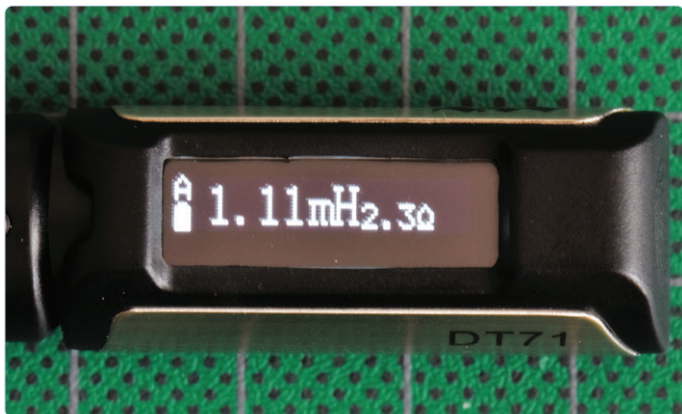
Figuur 4. Het OLED-display geeft meestal alleen de waarde weer, maar in de Auto-stand verschijnt soms nog een secundaire waarde zoals bij deze spoel.
