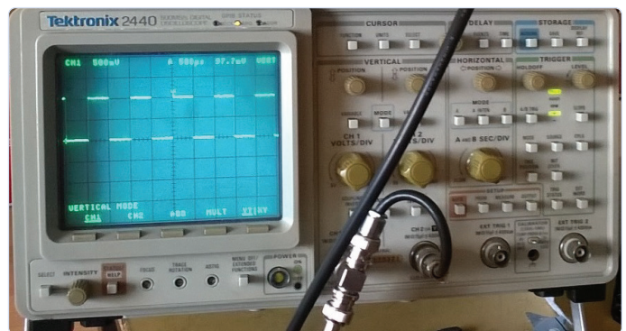
Figuur 2. De Tektronix 2440 tweekanaals digitale samplig oscilloscoop (300 MHz, 500 MS/s) uit de late jaren '80 (bron: tekwiki [2]).
