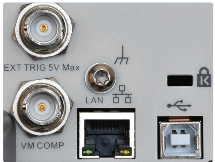
Figuur 3. De meter kan via USB of LAN met een PC worden verbonden.
