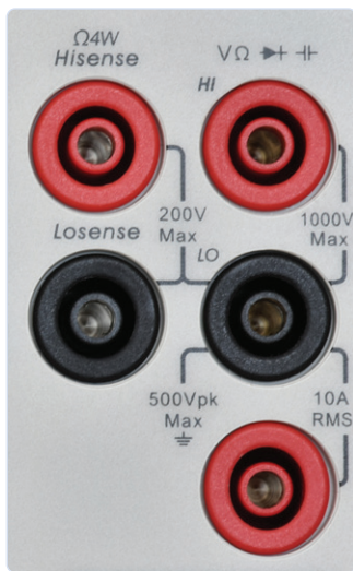
Figuur 1. Er zijn ingangsbussen aanwezig voor vierdraads weerstandsmetingen.
