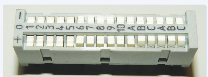
Figuur 7. Een driestanden 0/1/don't care DIP-schakelaar.
