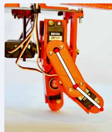
Figuur 3. Beide systemen gebruiken twee servo's om de beenpositie te besturen, maar op heel verschillende manieren.
