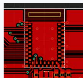
Figuur 5. Voorbeeld van Artemis op een PCB-layout.
