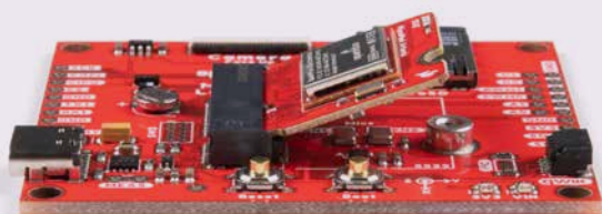
Figuur 3. De MicroMod-processorprint wordt onder een hoek van ongeveer 25° in de connector gestoken.
