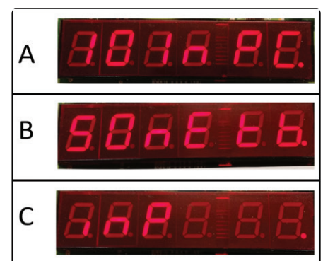
Figuur 7. A: 10 Input C. B: 50 Next B. C: Invoerprompt.
