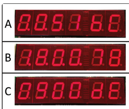
Figuur 5. A: Invoer van de waarde 81 dec in register BC. B: Startadres. C: Uitkomst 9 in register DE.
