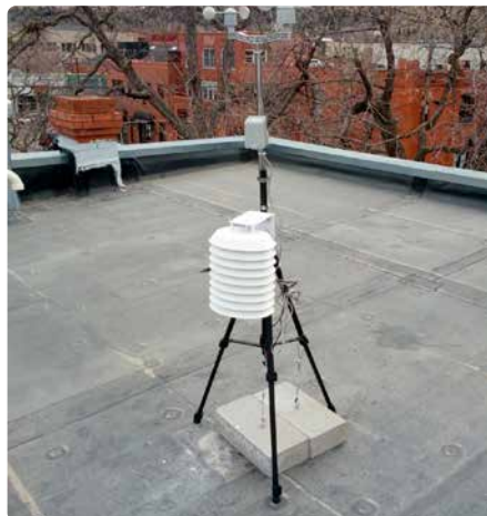
Figuur 2. Weerstation op een driepoot, gezeurd met zware stenen.
