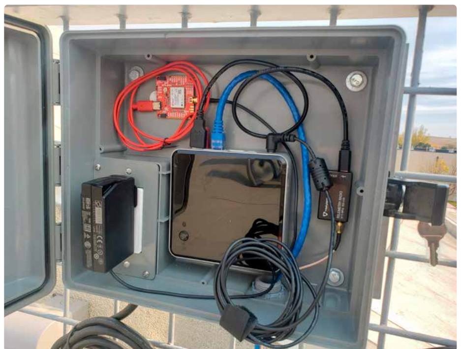
Figuur 19. Mini-PC verbonden met een ZED-F9P en een 915MHz-radio via USB.
