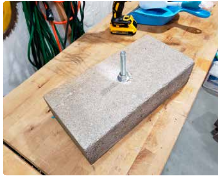
Figuur 5. Keilbout vastgezet met moer, en de betonsteen is nog heel!
