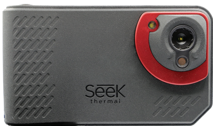
Figuur 1. Vooraanzicht met IR-lens, normale lens en LED-lichtbron.
