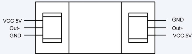
Figuur 3. Aansluitingen van de Hall-sensoren.
