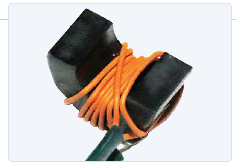
Figuur 4. Als de draad meerdere malen om de kern wordt gewikkeld, neemt de gevoeligheid toe.
