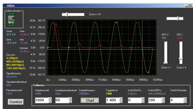
Figuur 3: De PC-software toont de netspanning (groen) en de stroom (rood). Hier is de spanning ingeschakeld tijdens een nuldoorgang (linker verticale grijze lijn) en negen nuldoorgangen later uitgeschakeld (rechter verticale grijze lijn).
