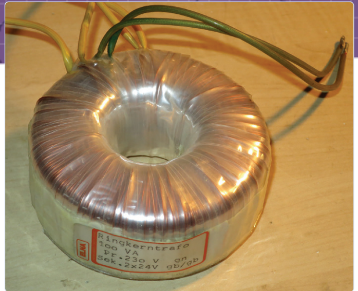
Figuur 4: De 100 W-ringkerntransformator die is gebruikt voor de experimenten.
