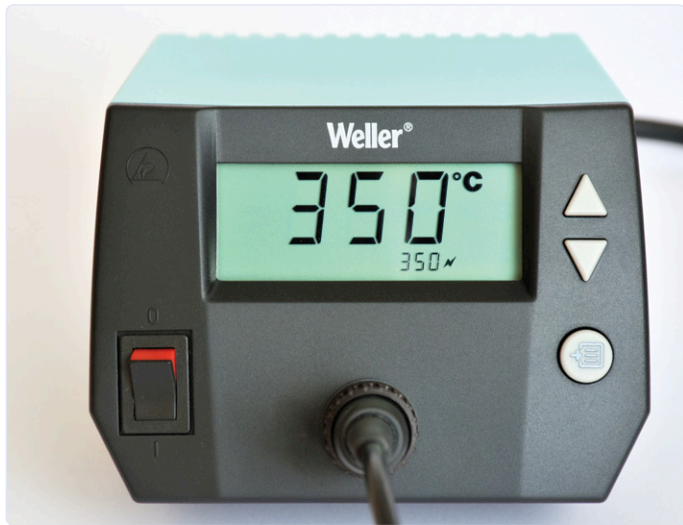
Figuur 2. Het display toont de temperatuur van de punt en daaronder wat kleiner de ingestelde waarde.
