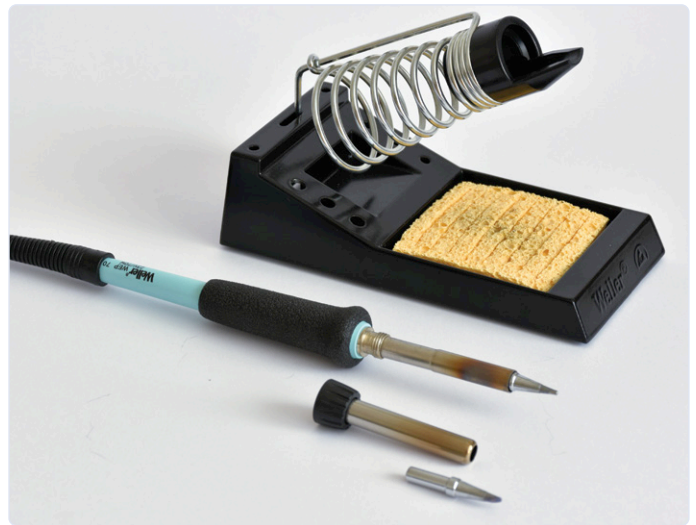
Figuur 3. Een punt wissel je gemakkelijk door de metalen huls los te schroeven.
