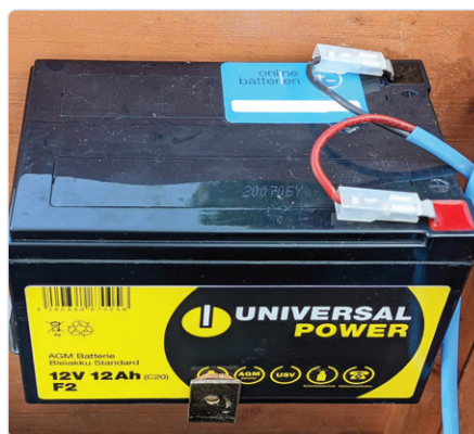
Figuur 3. De 12V-AGM-loodaccu met 12 Ah.
