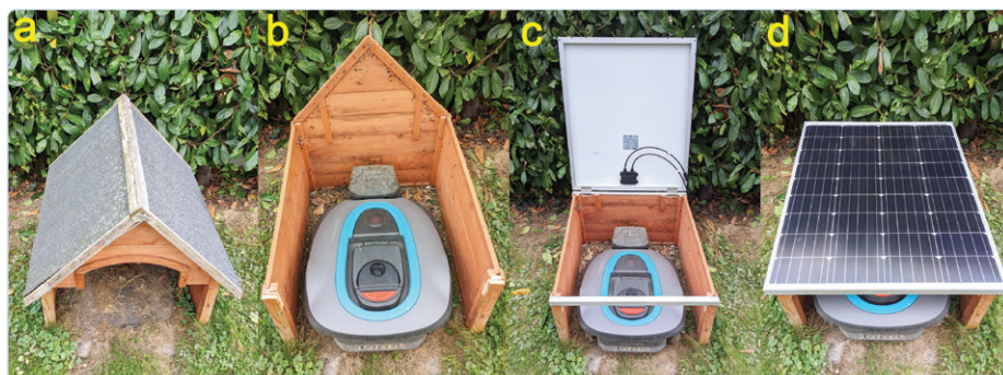
Figuur 6. De vier stadia van de ombouw van een hondenhok tot een solar-garage voor mijn maaierobot.
