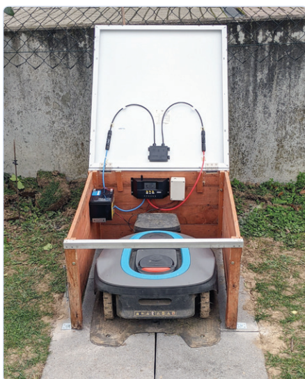
Figuur 10. Helemaal klaar: garage op zonne-energie met ingebouwde elektronica.
