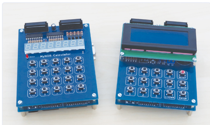
Figuur 4. Links de zakrekenmachine en rechts de MyNOR met toetsenbord(je) en display.
