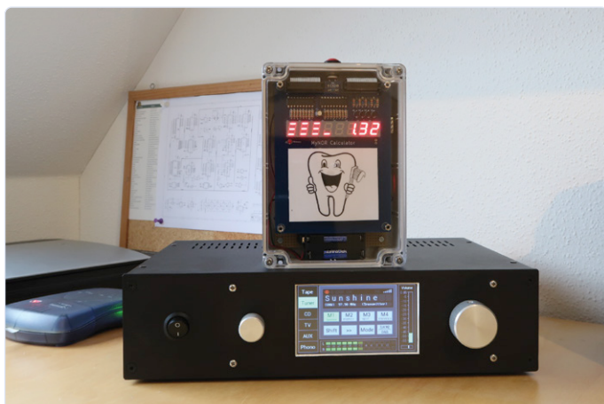
Figuur 5. Deze tandenpoetstimer bestaat uit MyNOR v1.0 plus de 7-segment-print v1.0. Het apparaat onder de timer is overigens een high-end receiver (FM en DAB+) met geïntegreerde 11-band equalizer en aanraakbediening, die die Dennis vorig jaar heeft gebouwd.
