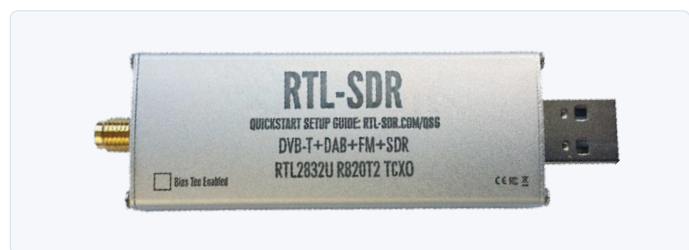
Figuur 2. De RTL-SDR decodeert veel draadloze signalen, waaronder weersensoren die op 433,92 MHz zenden.
