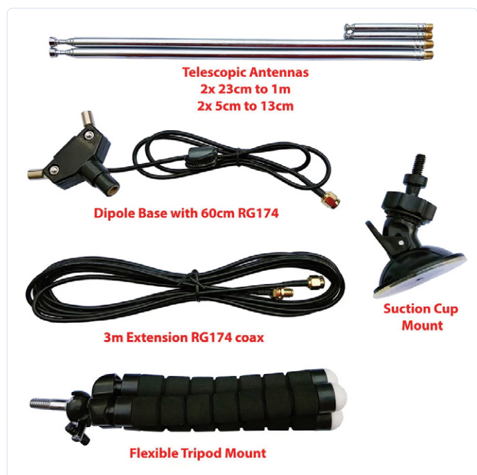
Figuur 3. Met het statief en de dipool- en telescoopantennes uit de RTL-SDR-set hebt u alles wat nodig is om metingen te ontvangen van al uw 433,92MHz-sensoren.
