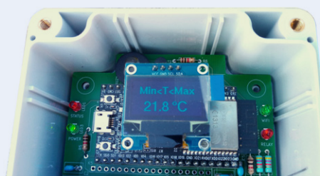
Figuur 3: De door Elektor Labs gebouwde thermostaat maakt gebruik van een ESP32 DevKitC-module met een afzonderlijke OLED-displaymodule.
