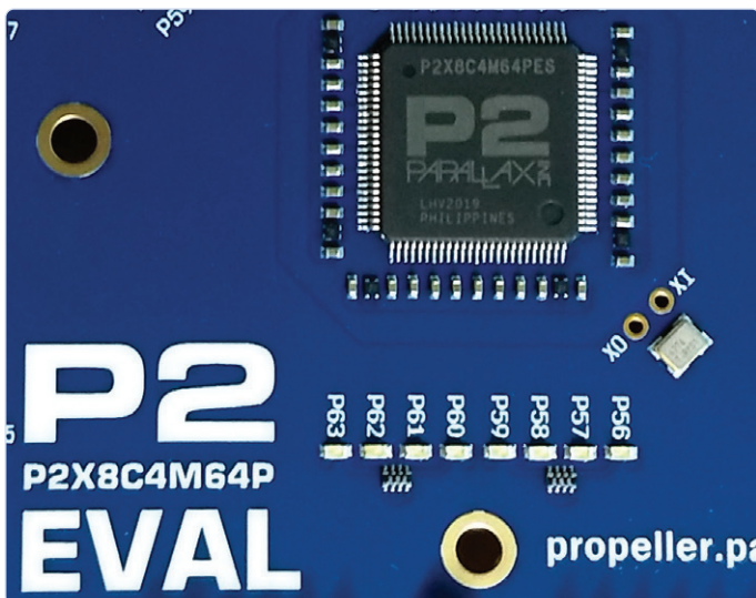
Figure 4. Close-up van de LED's die zijn aangesloten op MCU-pinnen 56...63.
