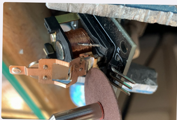
Figuur 3c. Verwijder het schakelcontact en een gedeelte van de kern.
