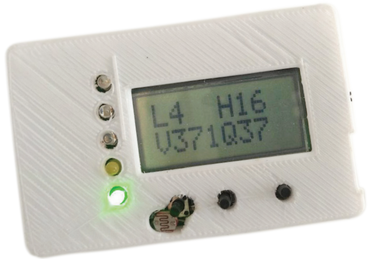
Figuur 3. Voorzijde van het PM2.5-display in een 3D-geprinte behuizing.
