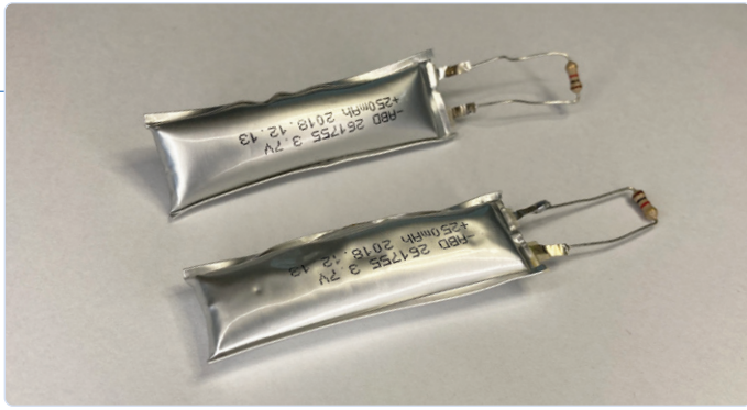
Figuur 8. Beschadigde en opgeblazen platte batterij.
