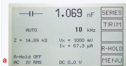
Figuur 5a. Meten van een kleine condensator bij een hoge frequentie.
