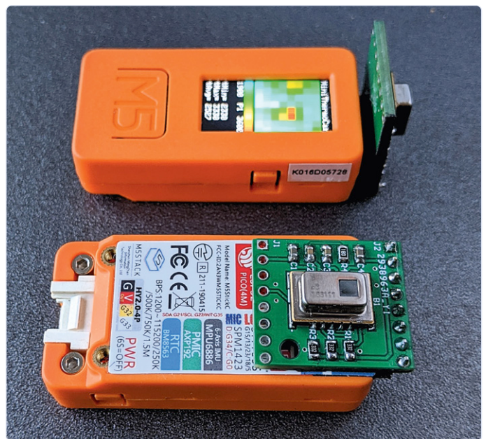
Figuur 6. Haaks of recht: twee manieren om de sensor aan de M5StickC te bevestigen.
