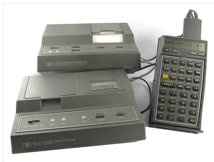
Figuur 2. Een HP-IL-systeem bestaande uit HP-41C, cassetteloopwerk en thermische printer.
