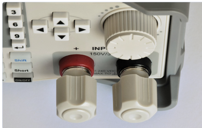
De grote schroefklemmen zijn heel stevig, maar bieden helaas niet de mogelijkheid om banaanstekkers te gebruiken.
