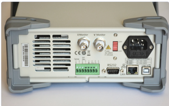
Het achterpaneel bevat een hele reeks aansluitingen en een aantal koelsleuven.
