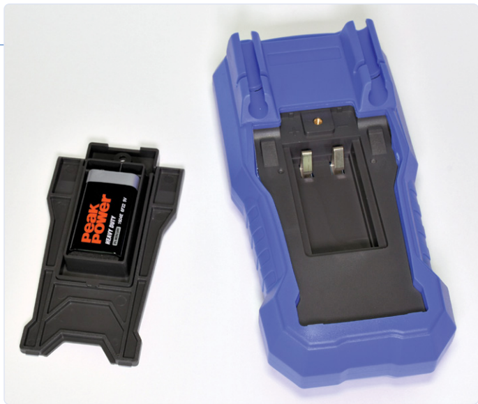
De 9-V-batterij zit in een aparte houder die in de meter wordt geklikt en vastgeschroefd.
