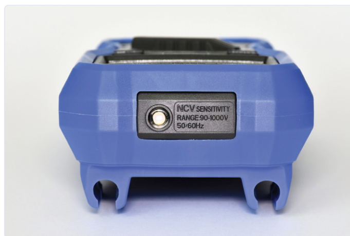
Aan de voorzijde zitten de NCV-sensor en een verlichtings-LED.
