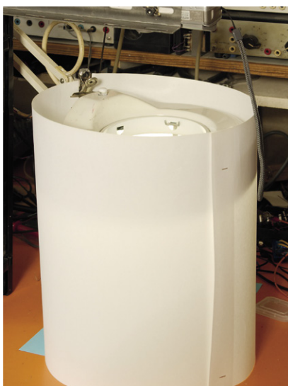
Figuur 4. Met een paar vellen papier kan de lichtverdeling sterk worden verbeterd.
