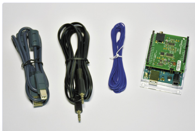
Figuur 2. Dit moet je zelf nog toevoegen: een Arduino Uno, USB-kabel, klinkstekerkabel en een stuk draad.
