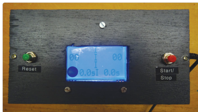
Figuur 3. Het display en de beide druktoetsen zijn in het deksel van de behuizing gemonteerd.
