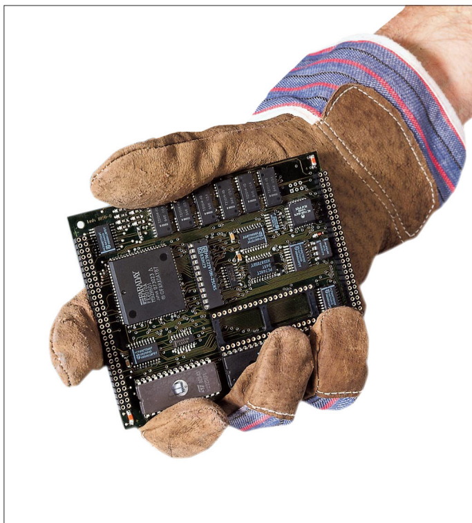
Figuur 2. De eerste ModulAT-modules van JUMPttec waren gebaseerd op de toen gebruikelijke AT/ISA96-bus en uitgerust met een 9,54-MHz Intel CPU 80C88 en 640 kByte DRAM-geheugen.
