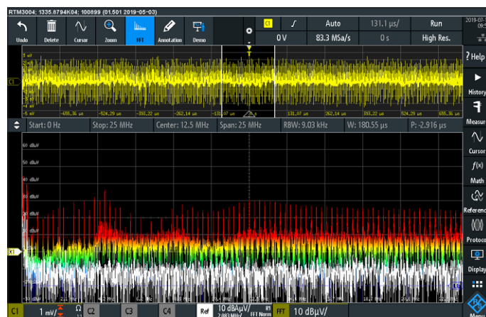
Figuur 4. Storingsspectrum van de schakelende voeding met ingangsfILTER: hier is duidelijk zichtbaar dat het spectrum in het onderste frequentiegebied wordt gedempt. De meting moet opnieuw worden uitgevoerd met de focus op dit frequentiegebied (bron: Rohde & Schwarz).
