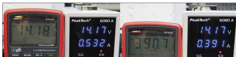
Figuur 3: Vergelijking van de weergave op de multimeter met die op het display van de voeding (boven spanning, onder stroom).
