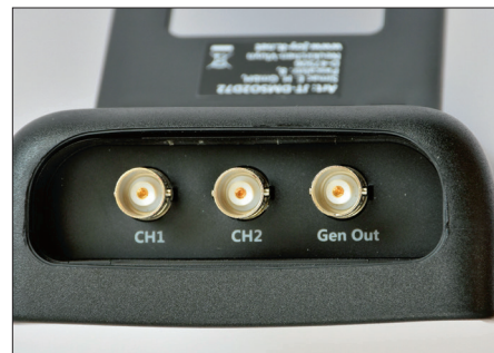
De BNC-bussen zitten vrij diep verzonken in de bovenkant van de kast.
