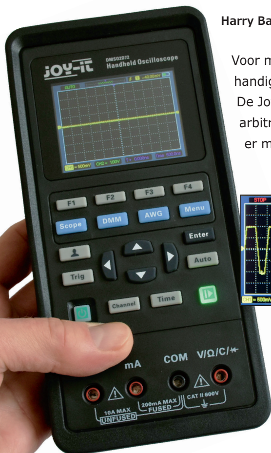
Naast elkaar: het scherm van de oscilloscoop, AWG en multimeter.
