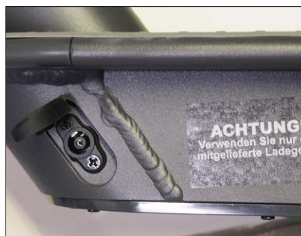
Figuur 13. Laadaansluiting aan de linkerzijde van de scooter.
