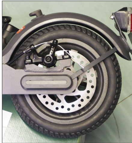
Figuur 8. Achterwiel met schijfrem en vergrendeling voor het neergeklapte stuur.
