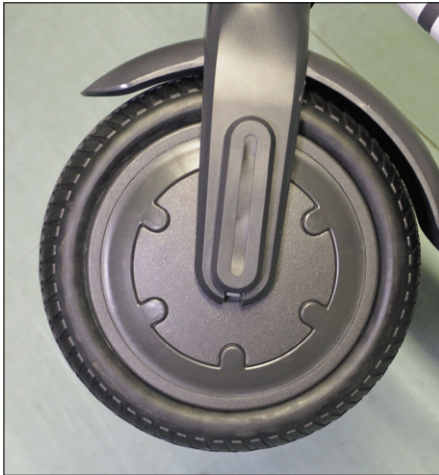
Figuur 7. Voorwiel met naafmotor en massief rubberen banden.
