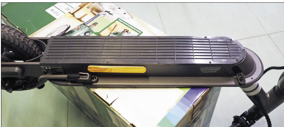
Figuur 9. De bodemplaat is gemaakt van kunststof en kan worden losgeschroefd.
