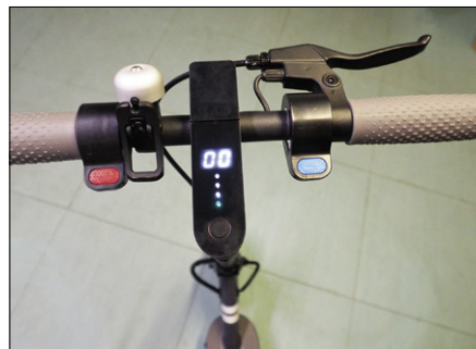
Figuur 5. Zo zien het stuur en het 'dashboard' er na inschakelen uit. De accu is leeg.
