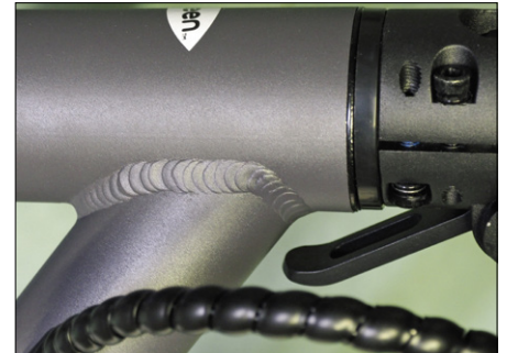
Figuur 6. Stevige lassen en inklapmechanisme.
