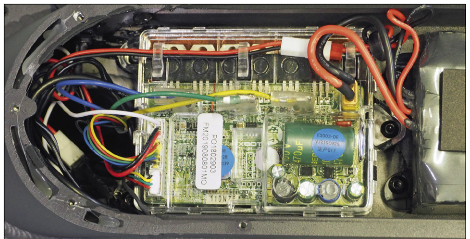
Figuur 12. De zes MOSFET's zijn duidelijk zichtbaar in de ingekapselde elektronica.
