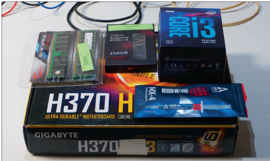
Figuur 1. De ingewanden van de van de lab-PC: moederbord, RAM, SSD, CPU en warmtegeleidende pasta.
