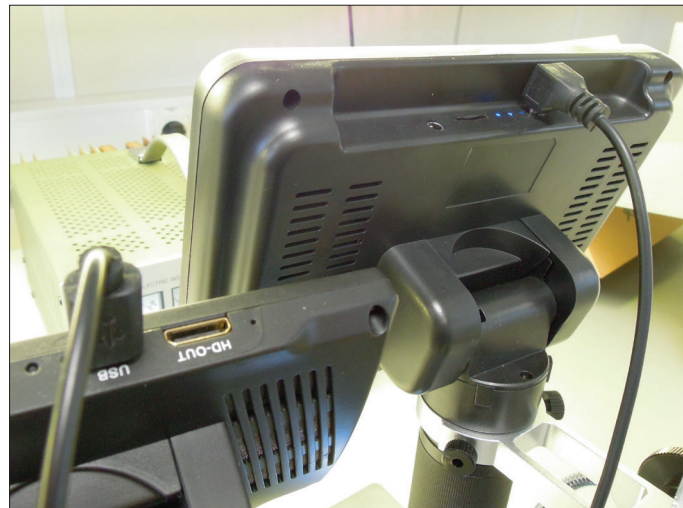
Figuur 3. Dankzij de haakse USB-stekker zal de kabel langer meegaan.
