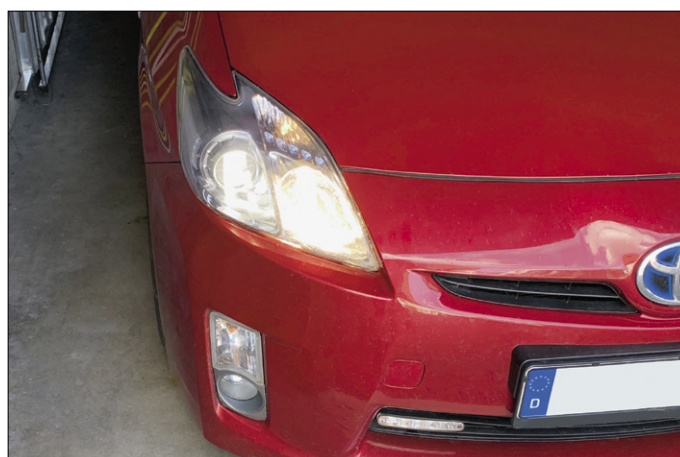
Figuur 10. Hoera: mijn Prius met 'getuned' dimlicht. U ziet de iets minder gelige kleur van het dimlicht, dat nu op 13,4 V (grootlicht op 11,8 V) werkt.
