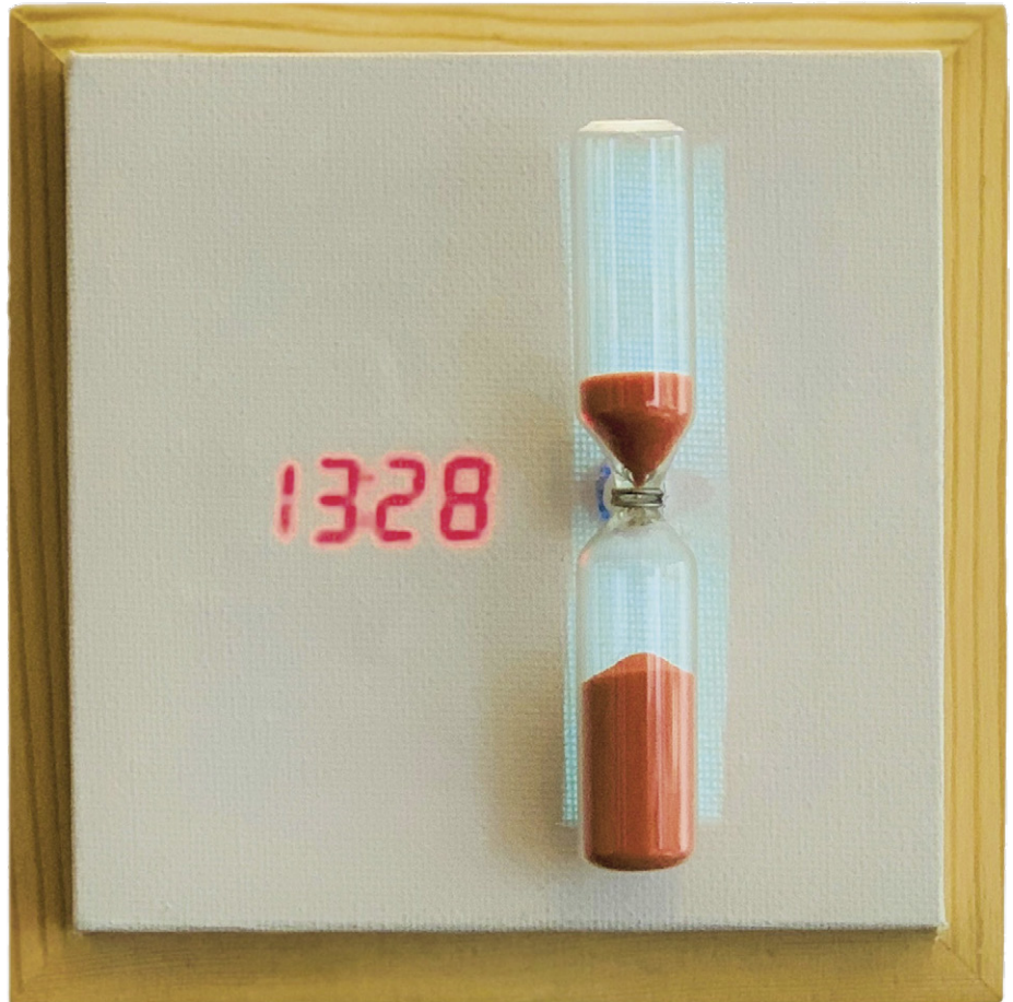
Figuur 1. De zandloper heeft links een viercijferige digitale klok en rechts een echte, verlichte zandloper die precies op tijd wordt gedraaid door een verborgen servo.
