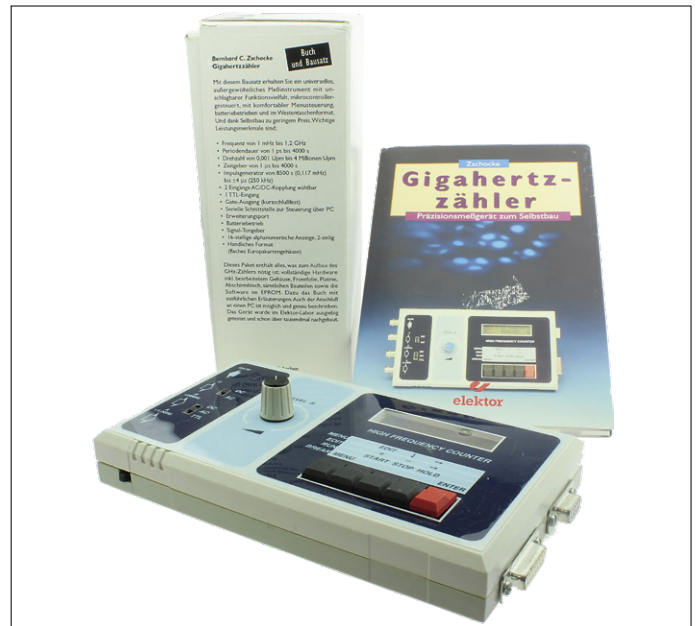
Figuur 4. De door Elektor Duitsland en een onderdelenleverancier verkochte 'bundel' bestond uit een boekje en een zeer complete onderdelenkit. De bundel verscheen voor het eerst in 1995, dus ruim na de publicatie van de GHz-teller in Elektuur.
