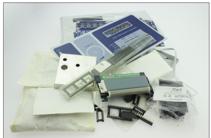
Figuur 5. Inhoud van de kit (1995). Omwille van de authenticiteit zijn niet alle papieren zakjes met componenten geleegd.
